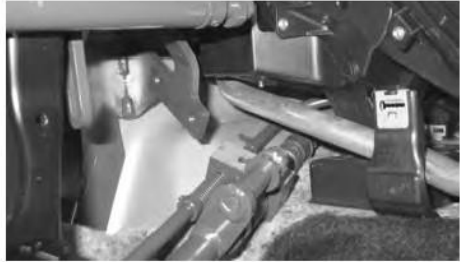
Bild 5-35: Skjut in mellandelen
