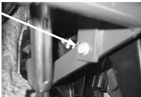
Bild 5-30: Skruva fast staget nedtill
