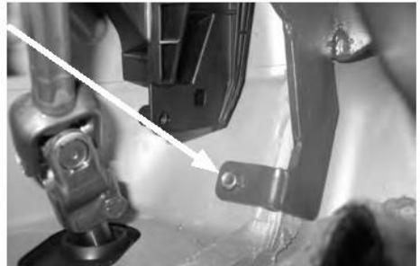
Bild 5-27: Skruva fast fästet
