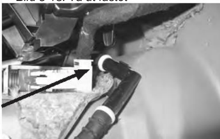
Bild 5-13: Ta ut fästet
