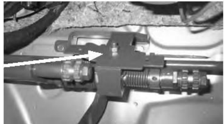
Bild 5-40 Halterung rechts verschraubt
