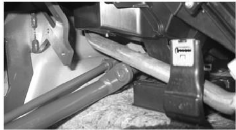
Bild 5-35: Skjut in mellandelen
