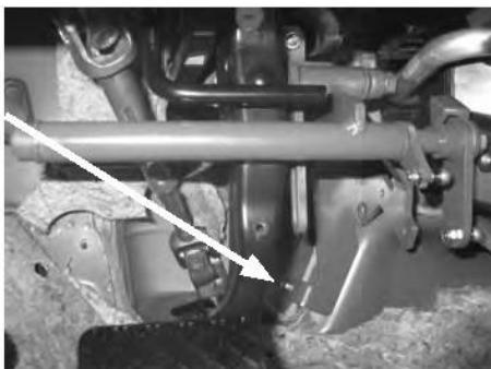
Bild 5-24: Fästet till vänster på tunneln
