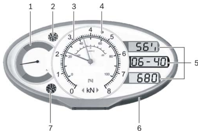
Fig. 3: Analogindikeringens 8kN indikeringsdetaljer
