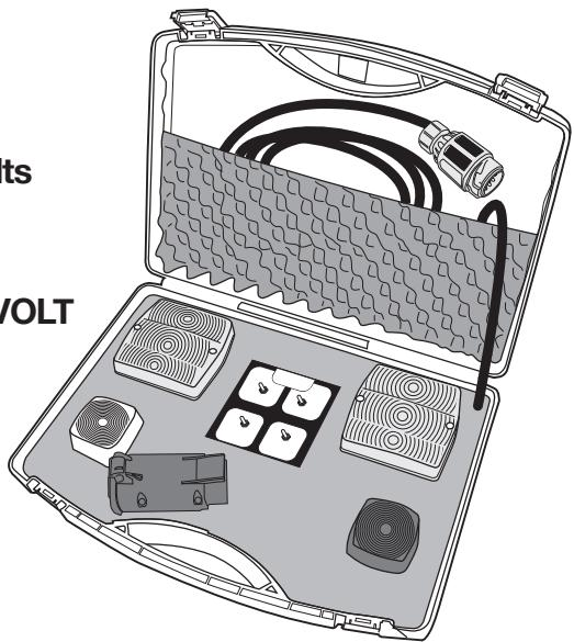
Das Prüfgerät dient zum Feststellen der Funktionsfähigkeit einer 12 Volt Anhängersteckdose und der gesetzlich vorgeschriebenen Anhängerblinkerüberwachung. Mit dem Prüfgerät können 13-polige Steckdosen nach ISO 11446 und, unter Zuhilfenahme des Adapters, 7-polige Steckdosen nach ISO 1724 geprüft werden. Im Prüfgerät finden für alle Funktionen handelsübliche Glühlampen Verwendung.
