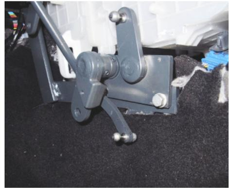
25. Die rechte Halterung (von oben) und das Schalterblech (von unten, in einigen Ländern nicht erforderlich) an den rechten Lagerbock anschrauben und oben über den Stehbolzen der Heizungsgehäusebefestigung schieben.
