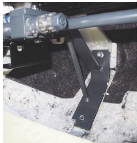
26. Dämmmatte und Isolierung unter der Halterung unten bis aufs Blech entfernen. Achten Sie bitte auf eventuell unter der Dämmmatte verlegte Leitungen oder Kabel.
