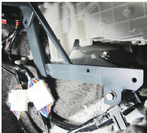
19. Halterung vorn mit den ausgedrehten Muttern festschrauben. Mutter M6 und die Schraube M6 x 20 am Tunnel festziehen.
