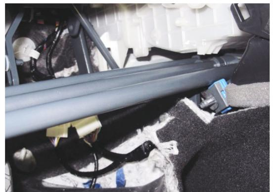
23. Den linken Lagerbock von links an die linke Halterung anschrauben.
