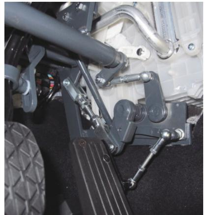
39. Schubstange für Gas in der Länge so einstellen, dass das Fahrlehrergaspedal ca. 20 mm tiefer als die Bremse steht, einhängen, kontern und sichern.
