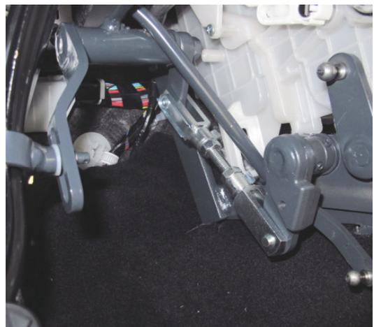
35. Mitnehmer für Kupplung mit dem Bolzen von rechts in die passende Vertiefung ganz einstecken. 2 x mit  $\varnothing$  3,5 mm bohren und Blechtreibschrauben 3,9 x 13 eindrehen.
