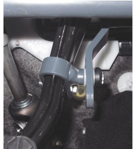
34. Schubstange für Bremse auf Länge einstellen, einhängen, kontern und sichern.
